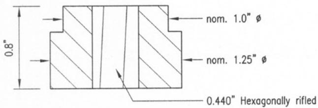
4. Section Through Extrusion Die
